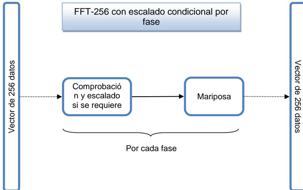
Figura 102. FFT-256 con escalado condicional por fase
