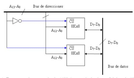
Figura 4 .Esquema de memoria de 16Kx8 a partir de dos módulos de 8Kx8
