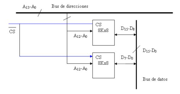
Figura 4 .Esquema de memoria de 16Kx16 con de dos módulos de 16Kx8
