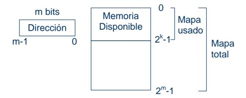
Figura 2: esquema de memoria de un computador.
