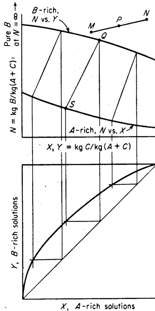
Figura 8.7: Equilibrio L/L. Diagrama de Janecke y curva de reparto (en base libre de disolvente)
