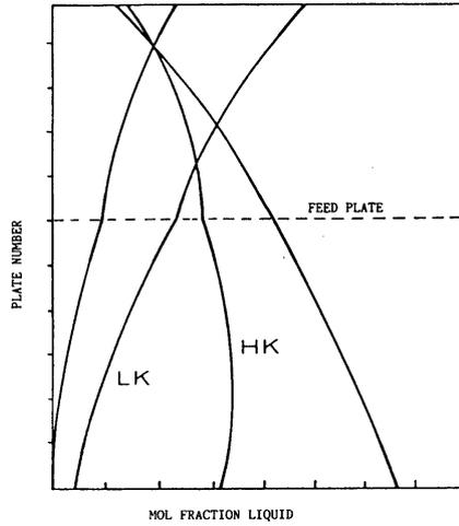
Figura 6.7: Componentes clave adyacentes (sin intermedios)
