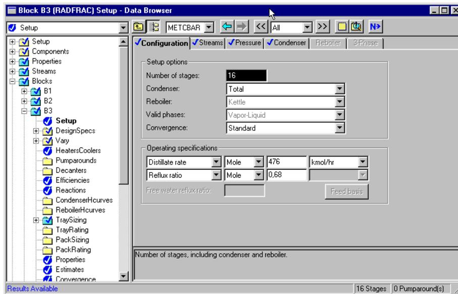
Figura 6.30: Cambio de caudal de destilado
