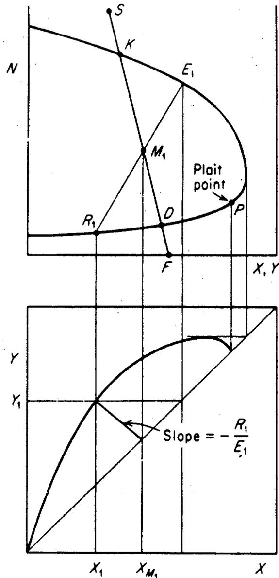
Figura 8.15: Cálculo de equilibrio L/L en diagrama de Janecke. Diagrama de reparto
