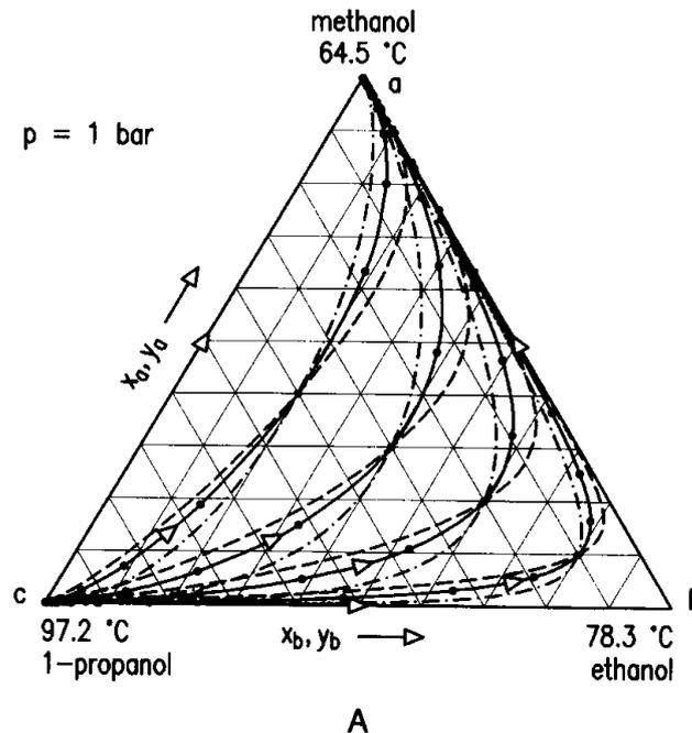
**Figura 10.5:** Curvas de residuo líquido y vapor y líneas de destilación
