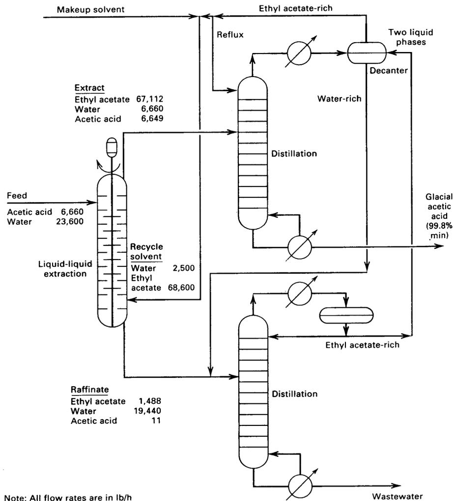
**Figura 8.1:** Extracción líquido-líquido y unidades auxiliares en la obtención del ácido acético glacial
