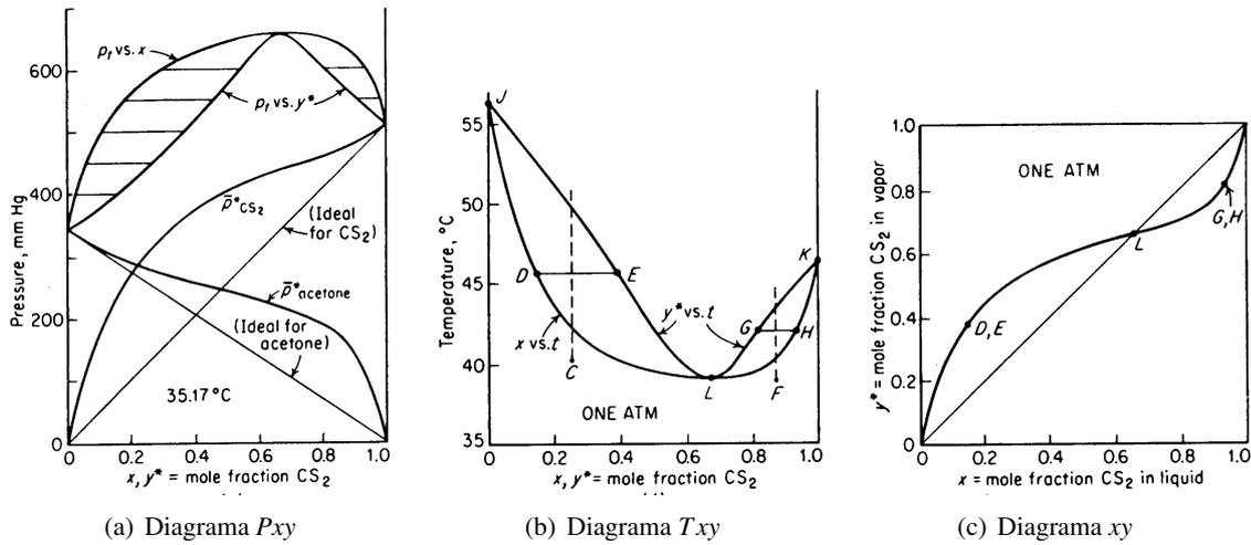
**Figura 2.6:** Equilibrio L/V con desviación positiva de la idealidad y azeótropo de mínimo punto de ebullición (Sulfuro de carbono - acetona)
