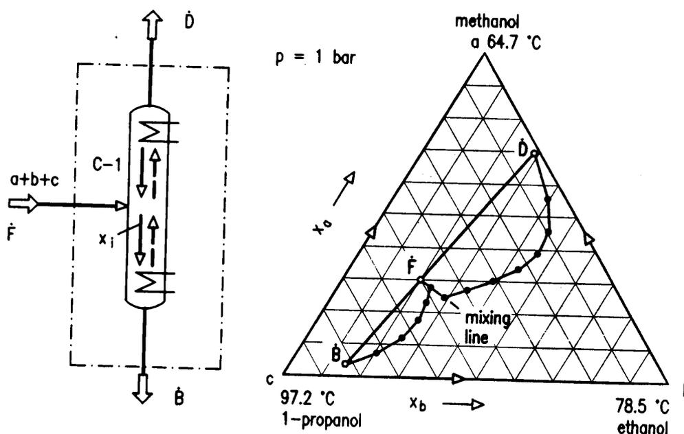
Figura 6.36: Destilación de un sistema ternario
