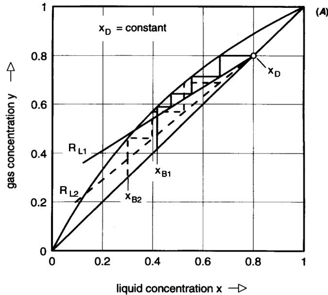
Figura 10.14: Destilación binaria con composición del destilado constante
