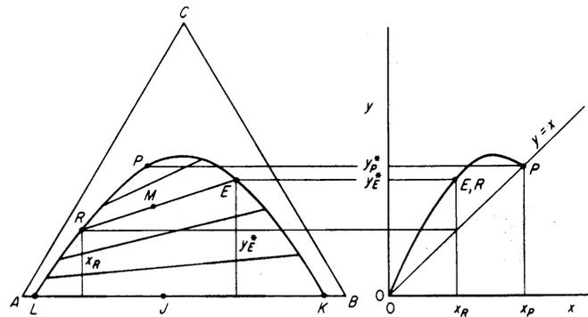
Figura 8.8: Equilibrio L/L. Dos componentes parcialmente miscibles
