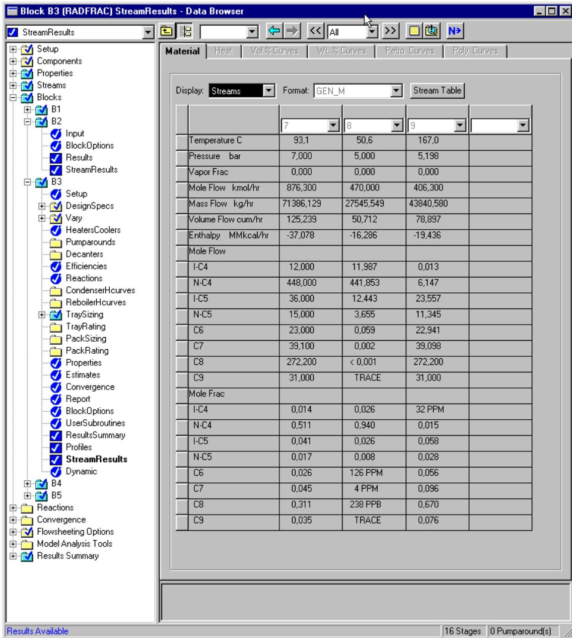
Figura 6.29: Resultados con nuevo ajuste de la relación de reflujo
