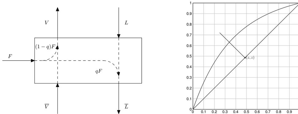
Figura 4.8: Recta de alimentación. Dos fases en la alimentación
