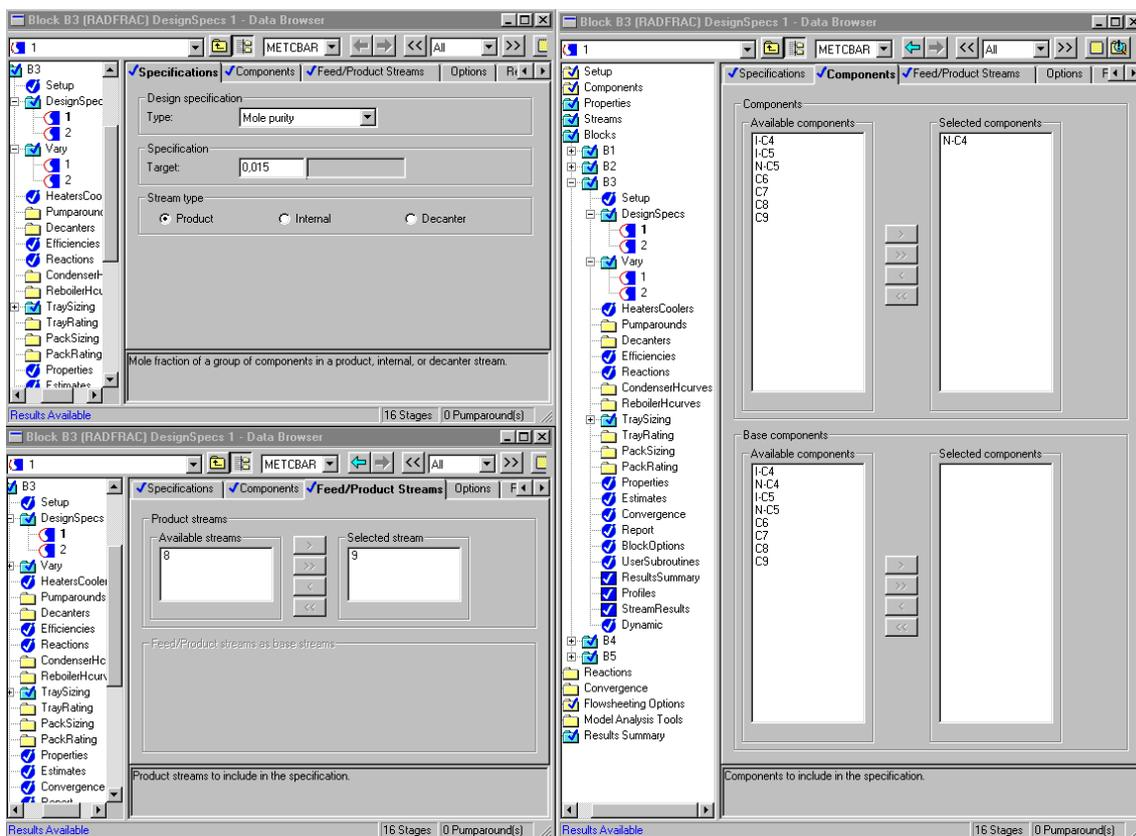
Figura 6.32: Especificación de diseño para la concentración del componente clave ligero en el fondo
