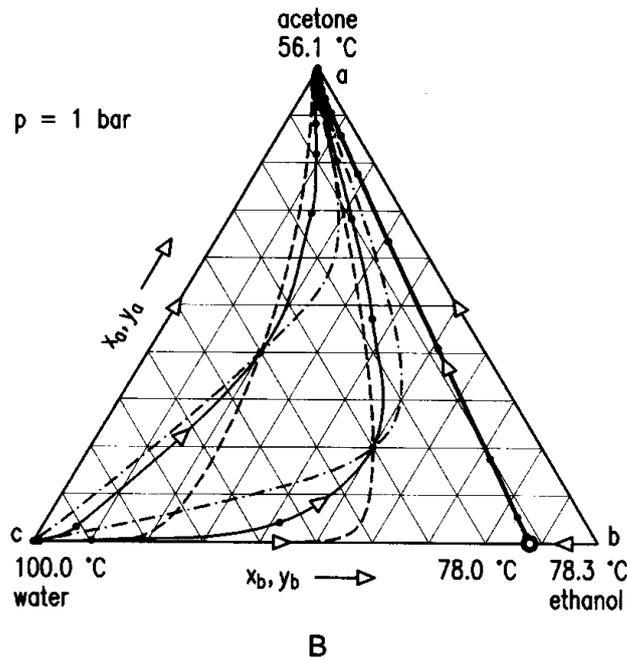
Figura 10.6: Curvas de residuo líquido y vapor y líneas de destilación
