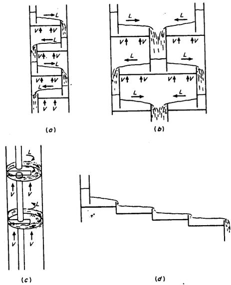
**Figura 5.20:** Disposición de flujo: (a) 1 paso (cruzado), (b) dos pasos (c) medio paso (invertido) (d) Cascada (escalonado)
