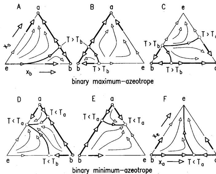
**Figura 7.16:** Criterios para selección de agente separador en destilación azeotrópica homogénea con cruce de líneas frontera
