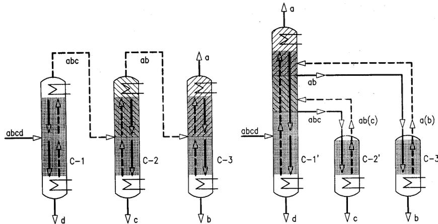
**Figura 7.5:** Columnas laterales para separación de una mezcla cuaternaria
