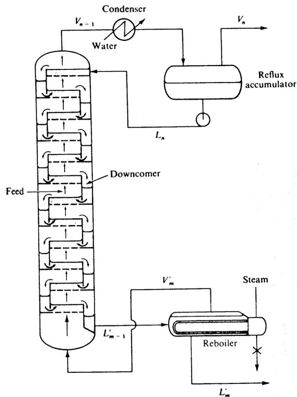
Figura 3.14: Columna de destilación
