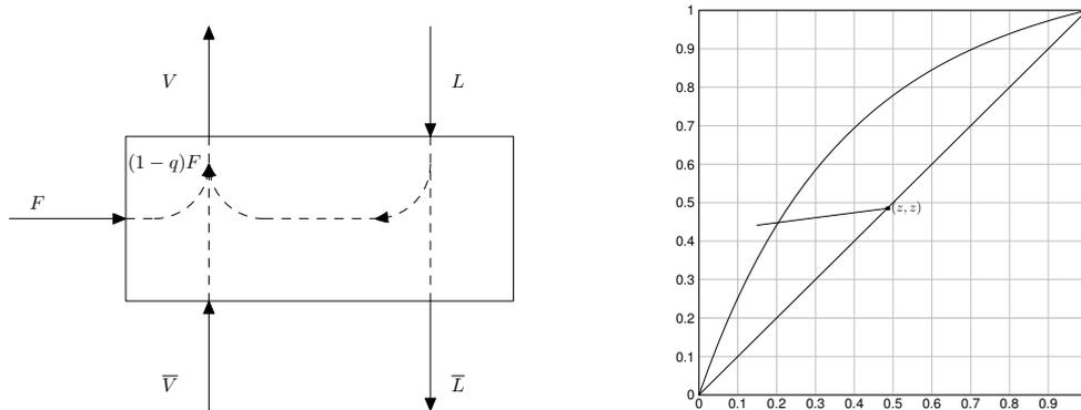
Figura 4.12: Recta de alimentación. Vapor sobrecalentado
