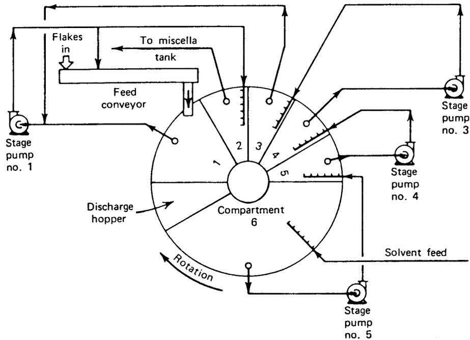
Figura 9.16: Esquema de funcionamiento del extractor Rotocel
