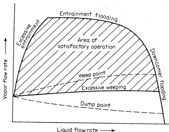
Figura 5.13: Diagrama de estabilidad para platos perforados
