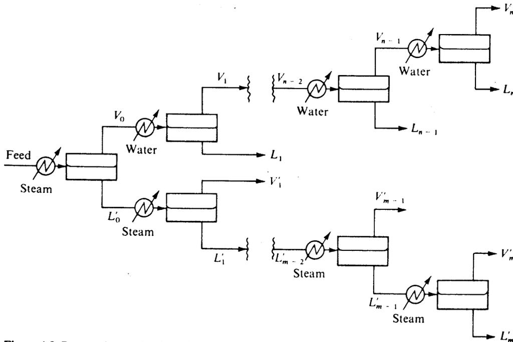
Figura 3.12: Purificación del componente ligero y pesado
