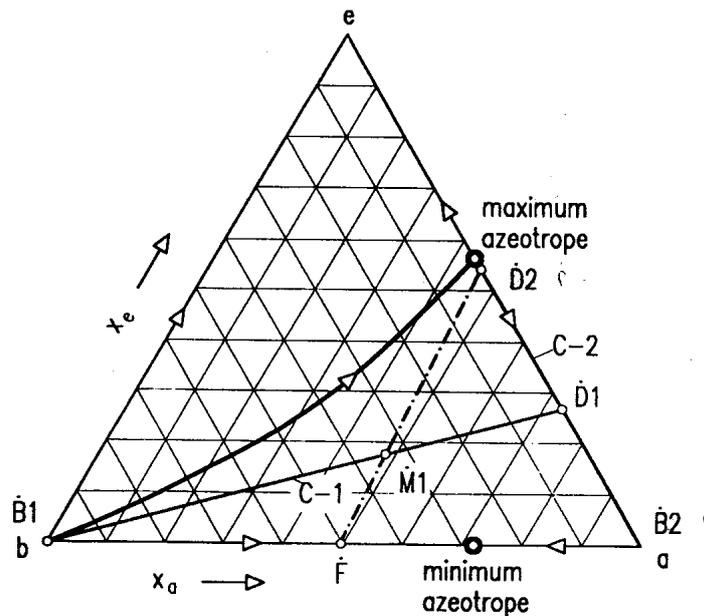
Figura 7.14: Destilación azeotrópica homogénea sin cruce de líneas frontera
