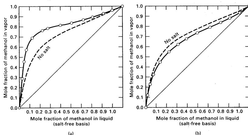
**Figura 7.10:** Efecto de la disolución de sales en el equilibrio L/V del sistema metanol/agua: (a) con disolución acuosa de nitrato sódico, (b) con disolución acuosa de cloruro de mercurio
