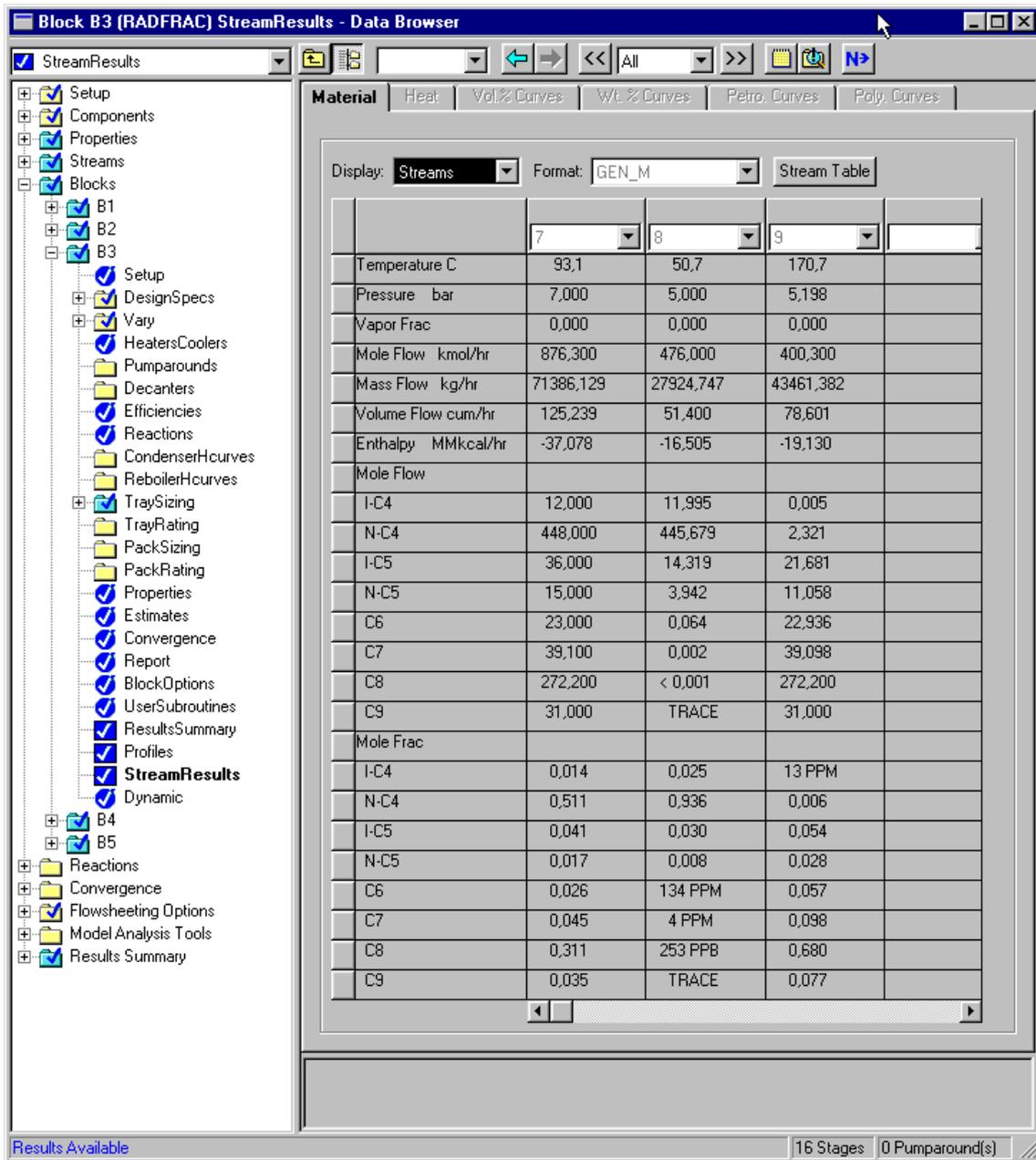
Figura 6.31: Resultados con cambio de caudal de destilado
