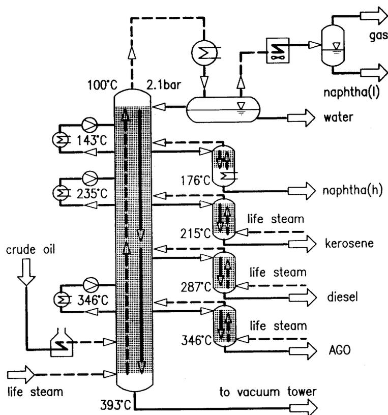
Figura 7.6: Columnas laterales en destilación de crudo
