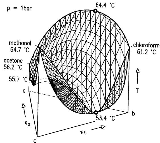
Figura 2.22: Superficie de punto de burbuja para equilibrio L/V de un sistema ternario.
