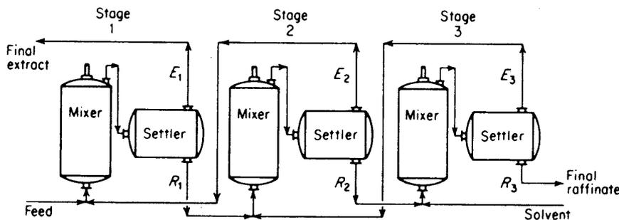
Figura 3.1: Grupo de mezcladores-sedimentadores para extracción líquido-líquido
