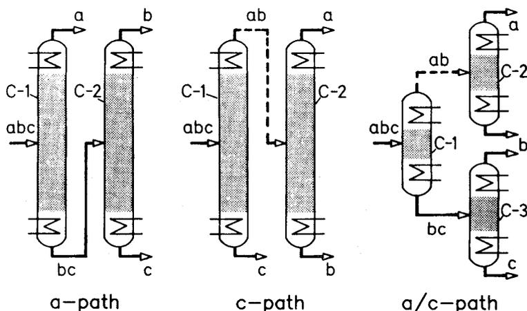
Figura 7.1: Secuencias para separación de una mezcla ternaria en sus componentes puros
