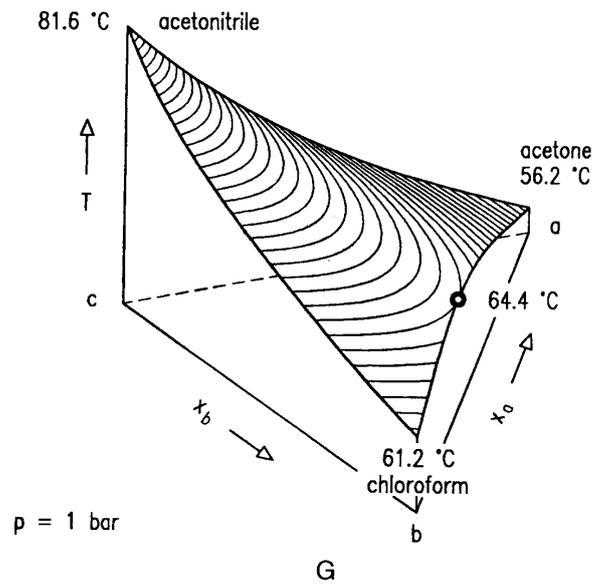
Figura 2.20: Superficie de punto de burbuja para equilibrio L/V de un sistema ternario.
