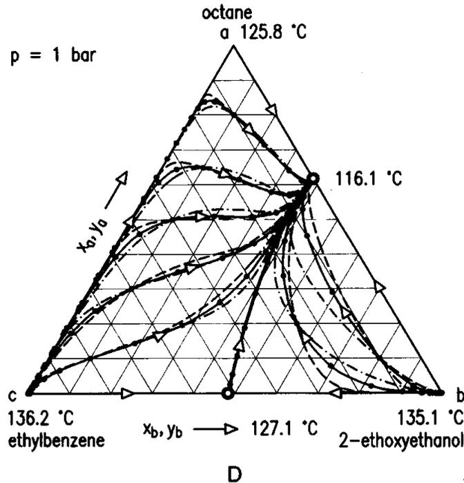
Figura 10.8: Curvas de residuo líquido y vapor y líneas de destilación
