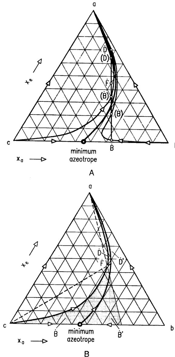
**Figura 6.49:** Separación de una mezcla ternaria con un azeótropo de mínima entre  $b$  y  $c$  cuando la alimentación está en la región cóncava de la línea frontera. B - Composiciones posibles de los productos
