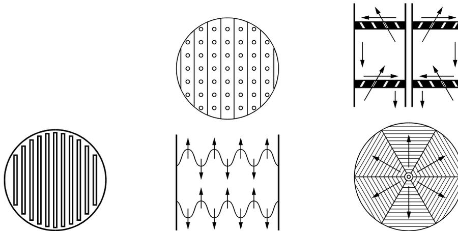
Figura 5.11: Platos tipo Turbogrid, Ripple y Kittel
