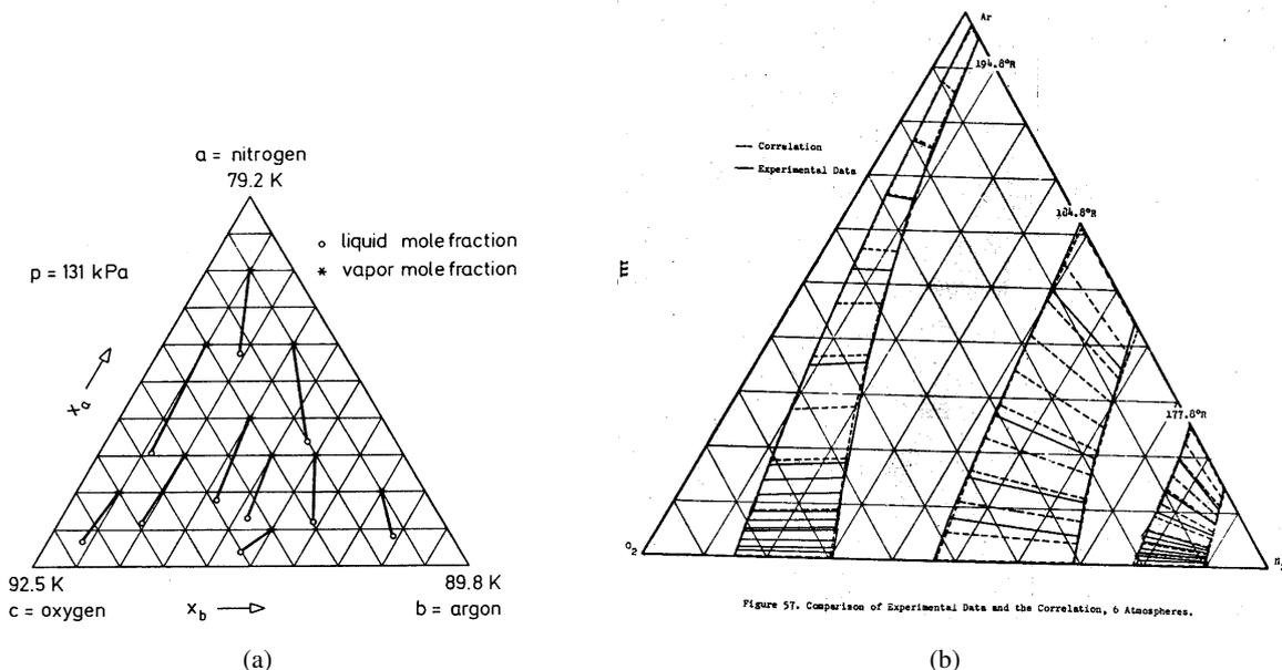
**Figura 2.12:** Diagrama triangular para equilibrio L/V de un sistema ternario. Pares de puntos en equilibrio
