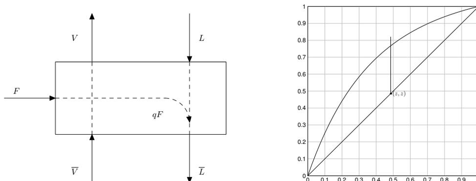
Figura 4.9: Recta de alimentación. Líquido saturado
