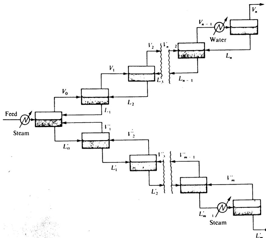
Figura 3.13: Reflujo y eliminación de intercambiadores
