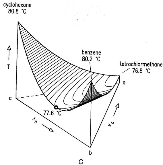
Figura 2.16: Superficie de punto de burbuja para equilibrio L/V de un sistema ternario.
