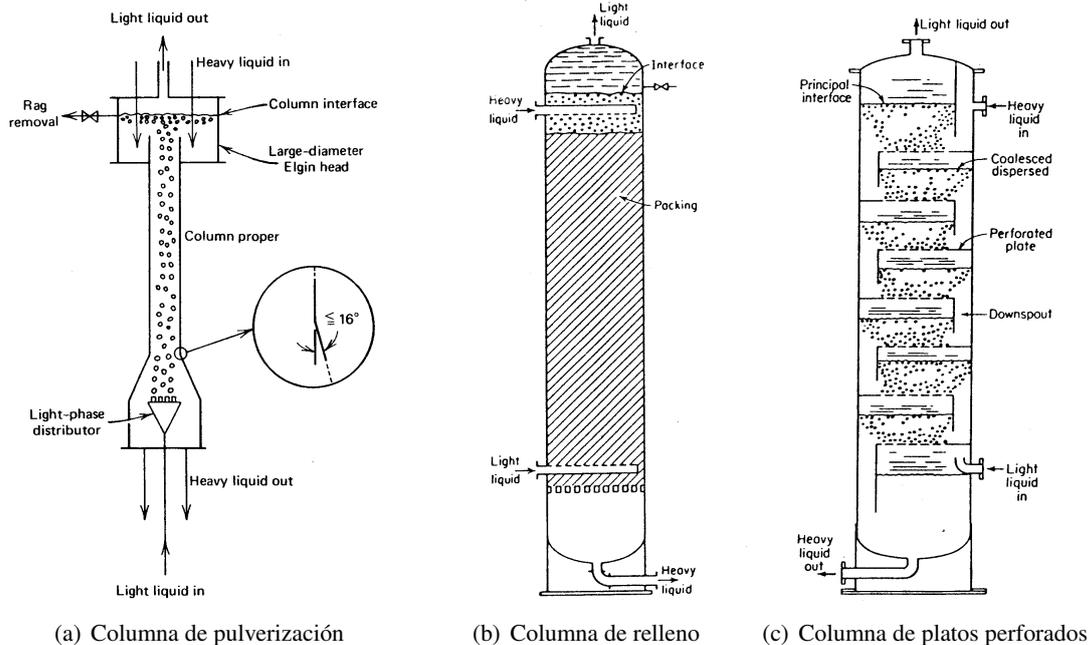
Figura 8.18: Columnas sin agitación
