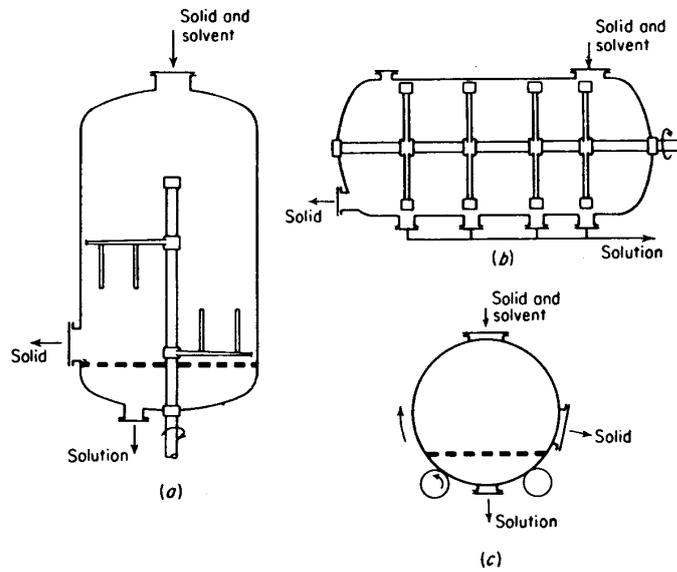
Figura 9.4: Lixiviación en tanques agitados
