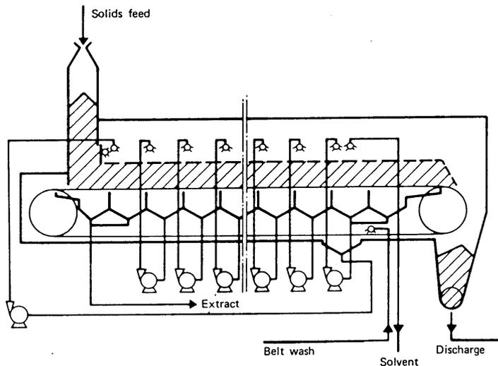
Figura 9.19: Extractor continuo horizontal sobre cinta continua
