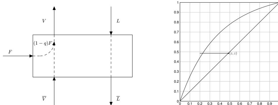
Figura 4.10: Recta de alimentación. Vapor saturado
