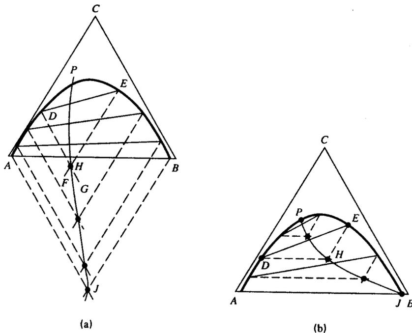
**Figura 8.30:** Métodos para determinar las rectas de reparto a partir de la curva conjugada
