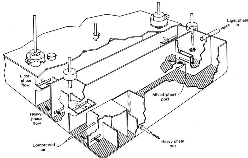
Figura 8.16: Sistema de mezcladores-sedimentadores
