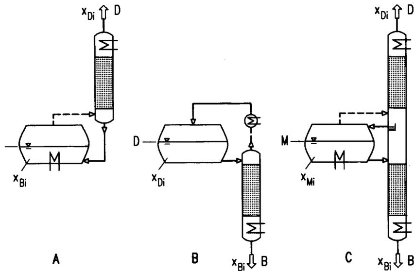
Figura 10.1: Configuraciones de columnas discontinuas
