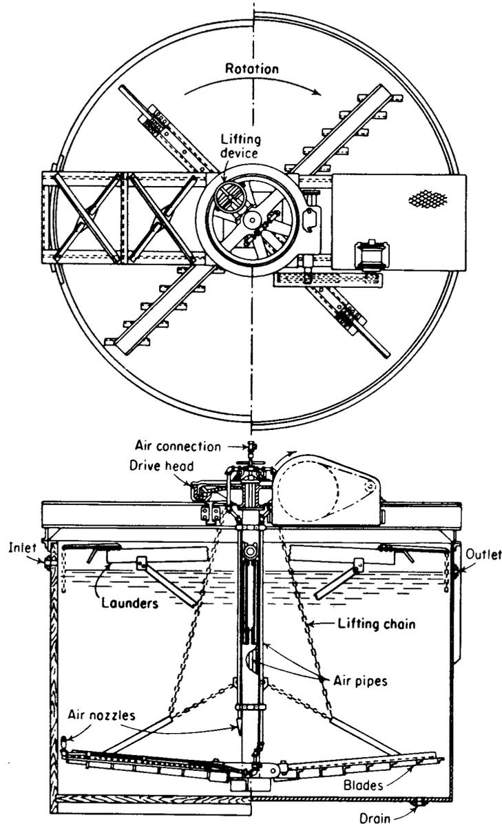
Figura 9.7: Tanque agitado tipo Dorr
