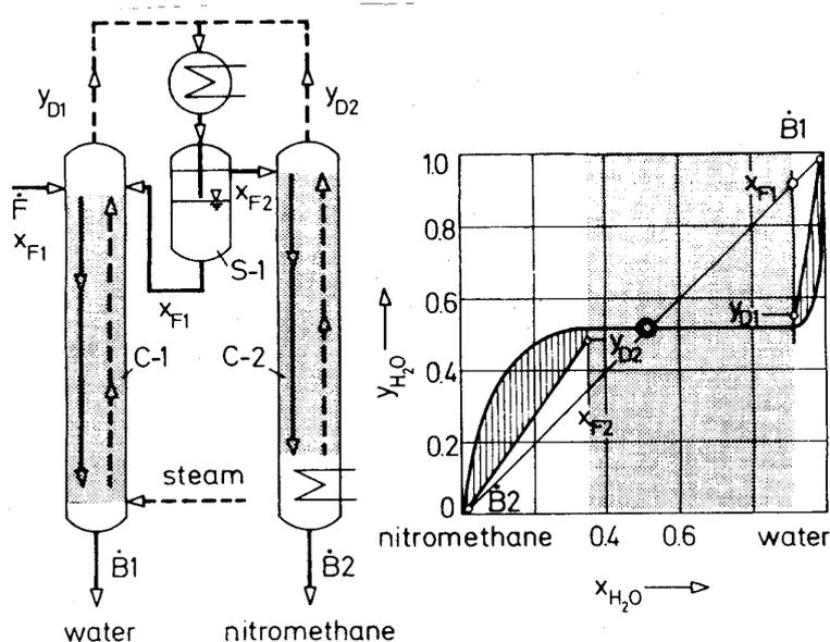
Figura 7.7: Separación de una mezcla que forma un azeótropo heterogéneo
