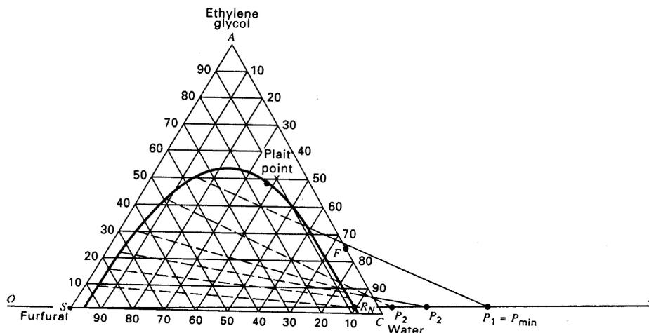
Figura 8.31: Determinación de la relación  $S_{\min}/F$
