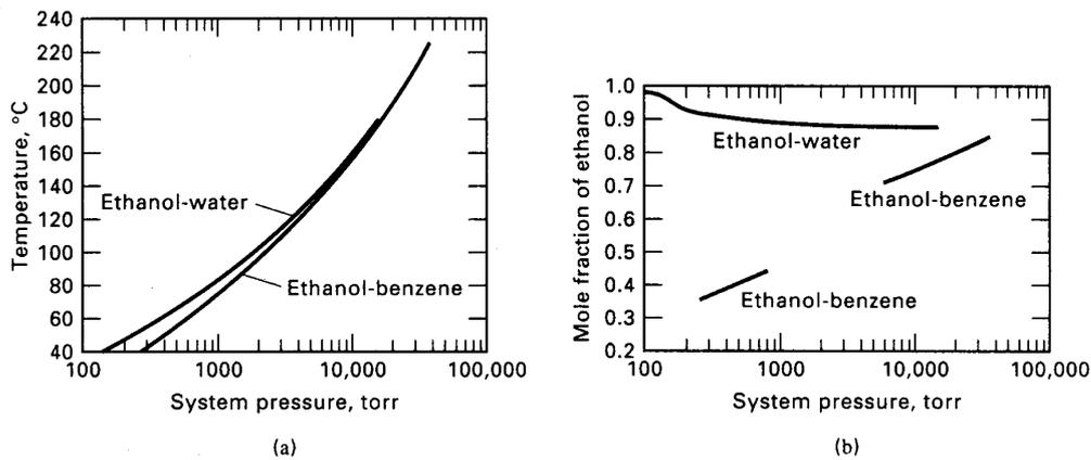
Figura 7.12: Efecto de la presión en la temperatura (a) y la composición (b) de azeótropos
