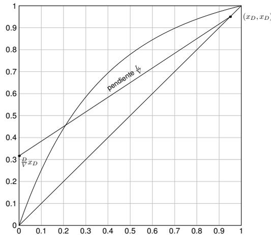
**Figura 4.4:** Recta de operación en rectificación
