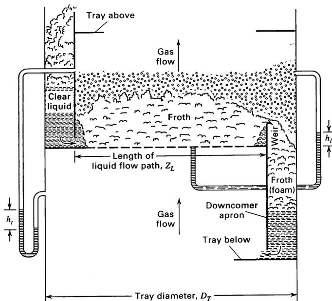
Figura 5.1: Esquema de un plato
