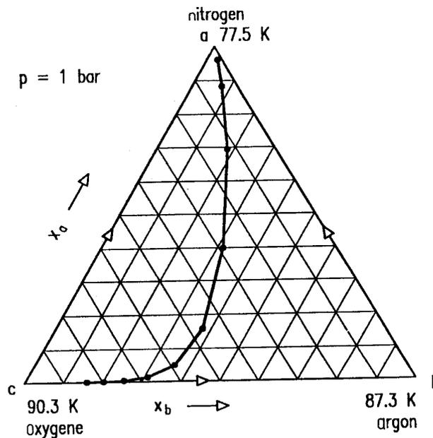
Figura 6.37: Determinación de una línea de destilación
