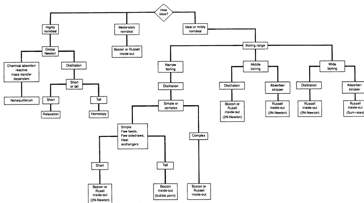
Figura 6.5: Selección de métodos de cálculo de destilación
