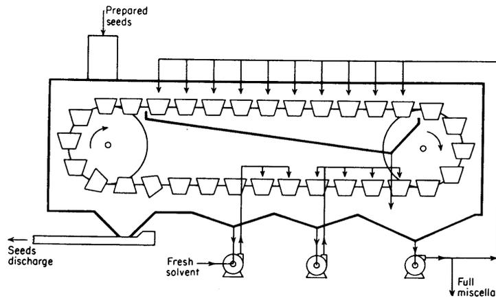
Figura 9.18: Extractor continuo horizontal con cangilones
