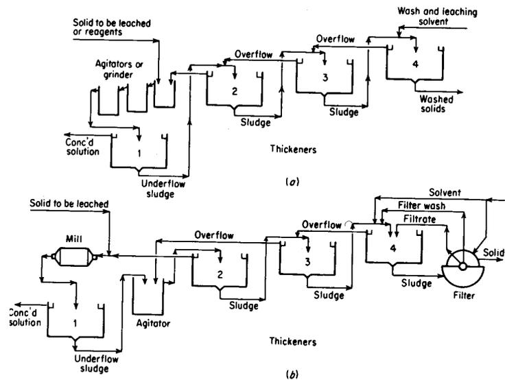
Figura 9.10: Lixiviación y lavado en contracorriente
