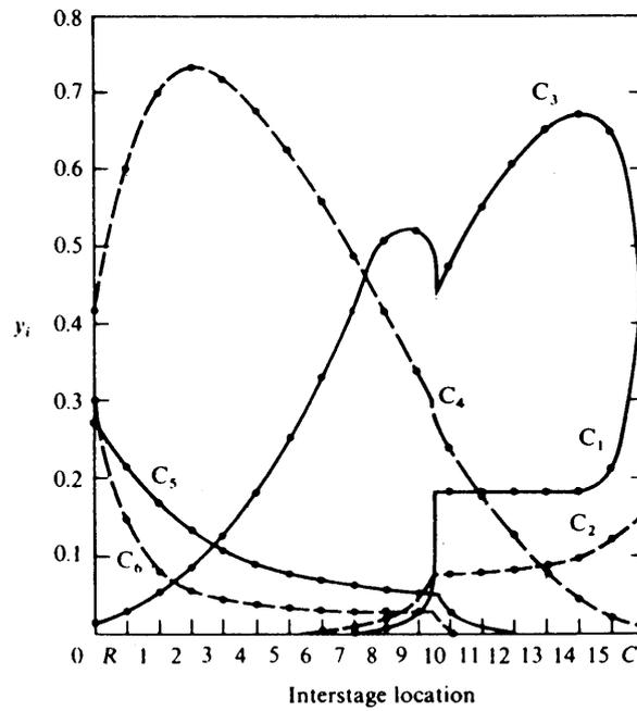
Figura 6.9: Composición del vapor en una despropanizadora
