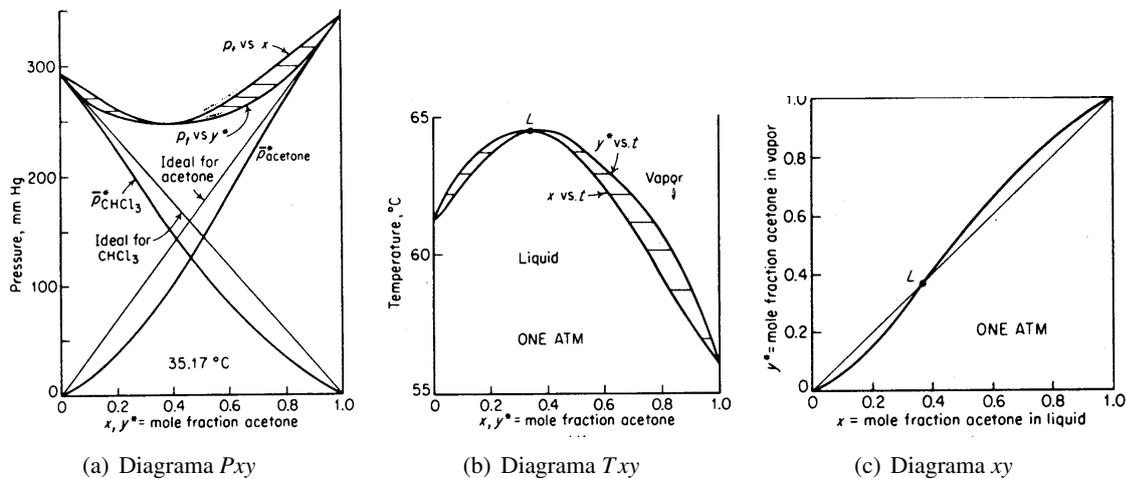
**Figura 2.8:** Equilibrio L/V con desviación negativa de la idealidad y azeótropo de máximo punto de ebullición (Acetona - cloroformo)
