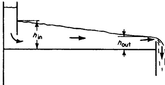
**Figura 5.21:** Gradiente hidráulico
