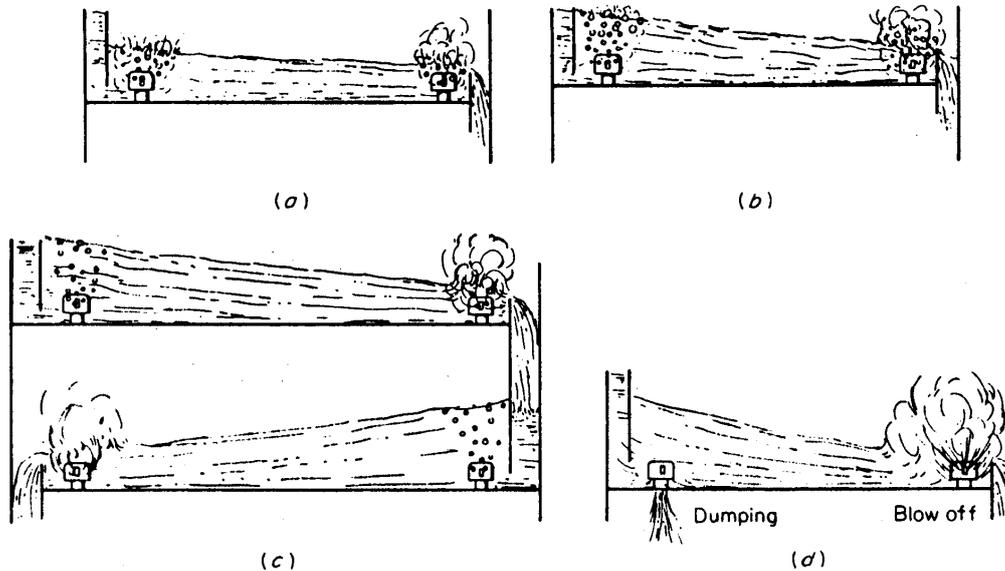
Figura 5.22: Inestabilidad de operación por gradiente hidráulico excesivo
