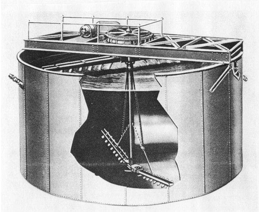
**Figura 9.6:** Tanque agitado tipo Dorr
