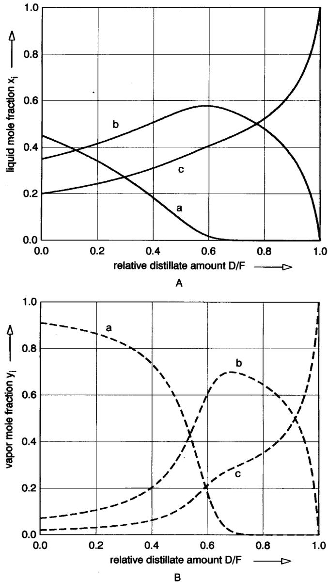
Figura 10.12: Evolución de las composiciones en la destilación diferencial de un sistema ternario
