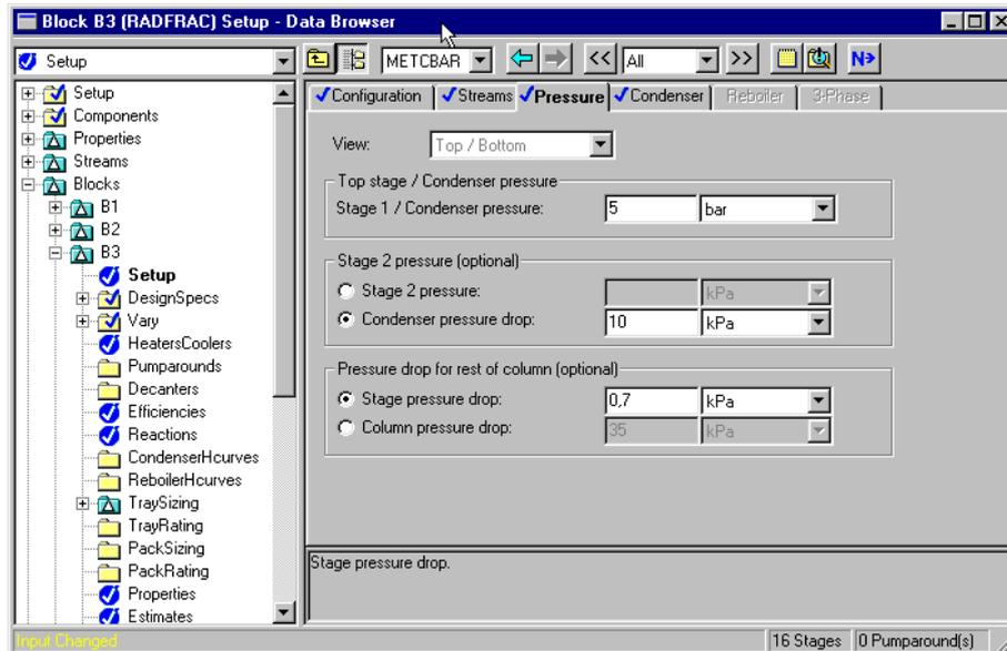
Figura 6.21: Pérdida de carga por etapa y en condensador
