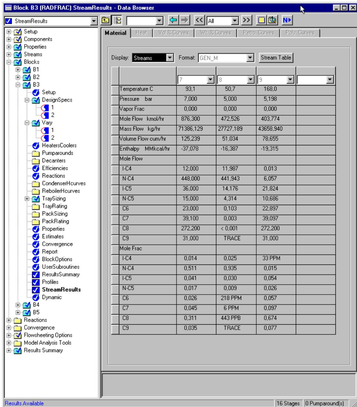
Figura 6.35: Productos finales en la columna diseñada
