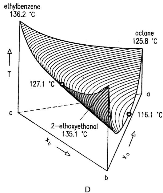
Figura 2.17: Superficie de punto de burbuja para equilibrio L/V de un sistema ternario.
