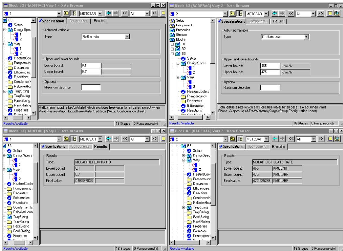
Figura 6.34: Asignación de variables manipuladas para conseguir especificaciones de diseño y resultado
