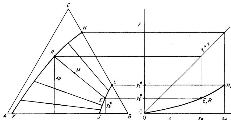
Figura 8.9: Equilibrio L/L. Dos pares de componentes parcialmente miscibles
