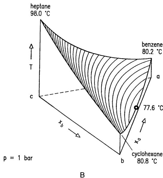
Figura 2.15: Superficie de punto de burbuja para equilibrio L/V de un sistema ternario.
