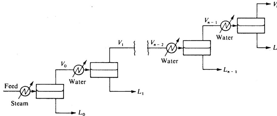
**Figura 3.9:** Purificación del componente ligero
