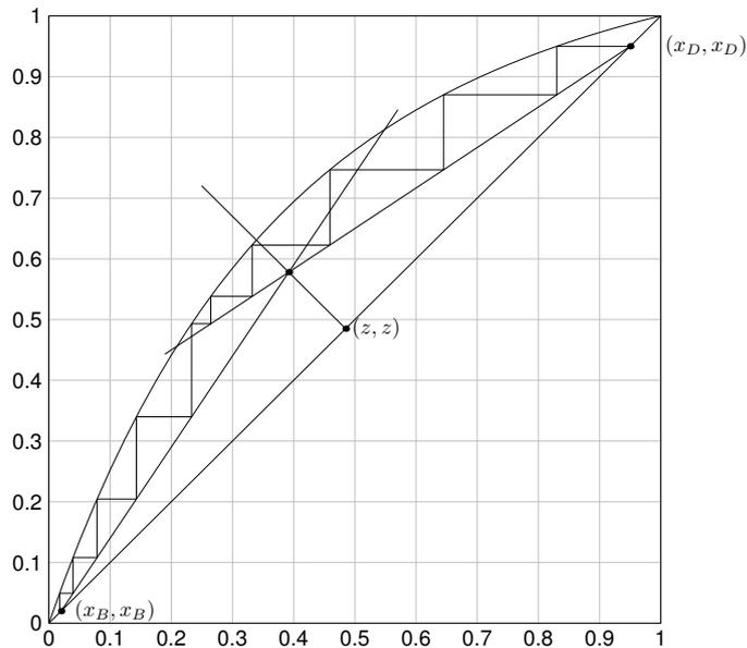
**Figura 4.15:** Plato de alimentación por debajo del óptimo
