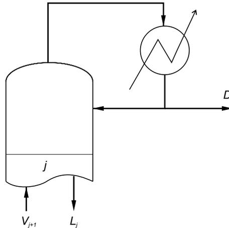
**Figura 4.3:** Balance a la parte superior de la columna
