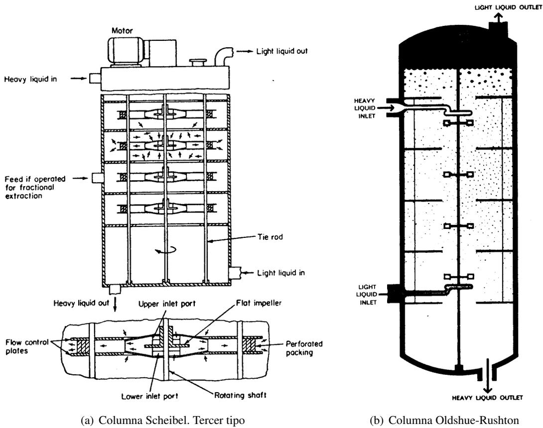
Figura 8.22: Columnas con agitador rotativo II
