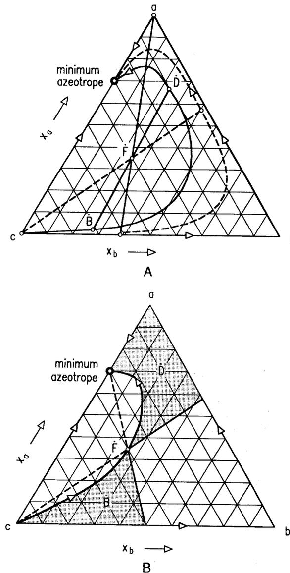
Figura 6.48: Separación de una mezcla ternaria con un azeótropo de mínima entre  $a$  y  $c$ . B - Composiciones
