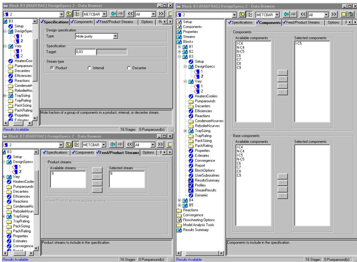
Figura 6.33: Especificación de diseño para la concentración del componente clave pesado en el destilado
