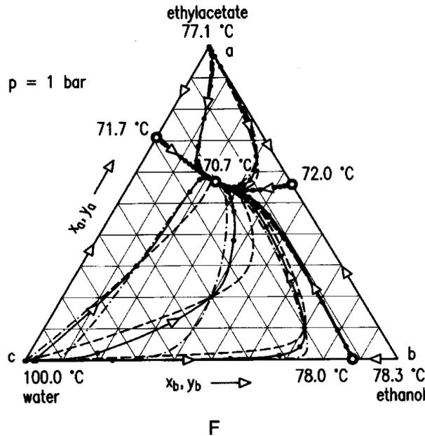
Figura 10.10: Curvas de residuo líquido y vapor y líneas de destilación
