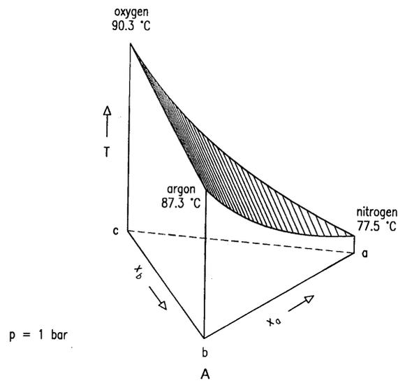
Figura 2.14: Superficie de punto de burbuja para equilibrio L/V de un sistema ternario.
