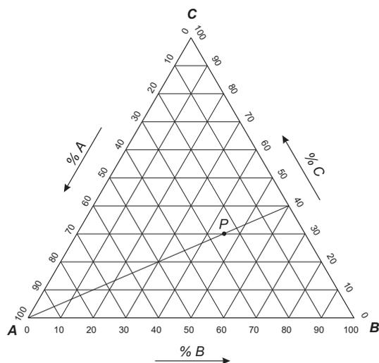
Figura A.5: Relación constante de composiciones para  $B$  y  $C$
