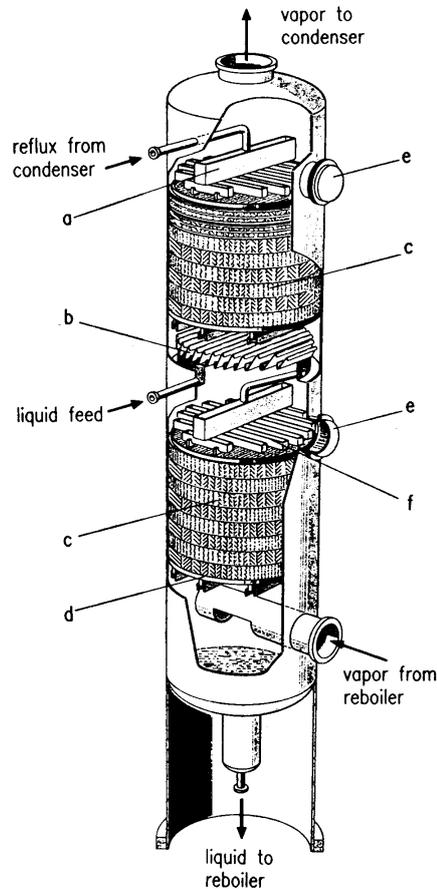
**Figura 3.3:** Columna de relleno
