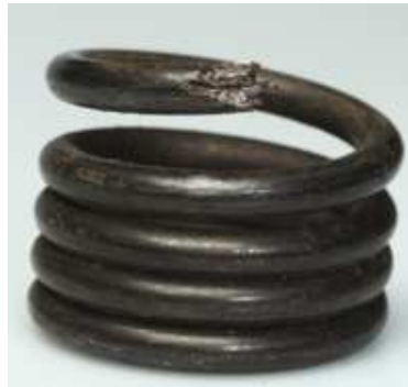
Figura 5.6 - Rotura por fatiga de un resorte helicoidal
