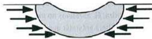
Figura 4.4 – La compresión se opone a la fisura
