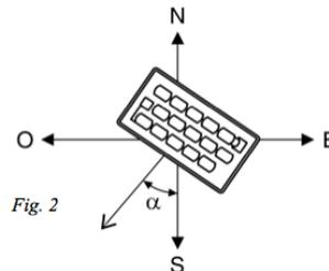
Habiendo determinado el ángulo de azimut del generador, se calcularán los límites de inclinación aceptables de acuerdo a las pérdidas máximas respecto a la inclinación óptima.
