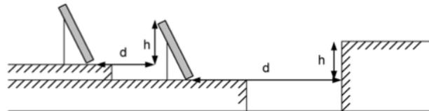
Finalmente, optaremos por una **separación** median entre filas de **4,50 metros**, apta también para el paso de vehículos destinados al mantenimiento de las placas.
