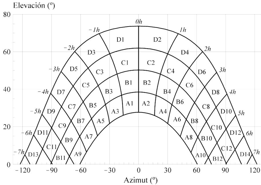
Fig. 5. Diagrama de trayectorias del Sol.
